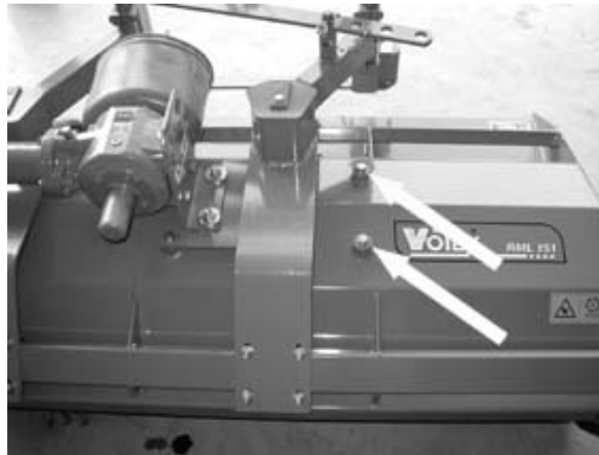
Figuur 5.5.1 Tandwielkast in het midden.
